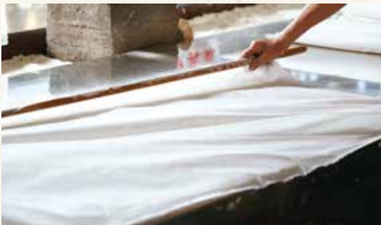
抄製後的紙張經一天的靜置、壓乾，再由烘紙師傅一張張烘乾
