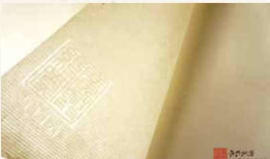
不同的紙款有不同的紋路，是利用抄紙時使用不同編法的竹簾製成，廣興多樣的簾紋是黃煥彰與藝術家們討論的成果
