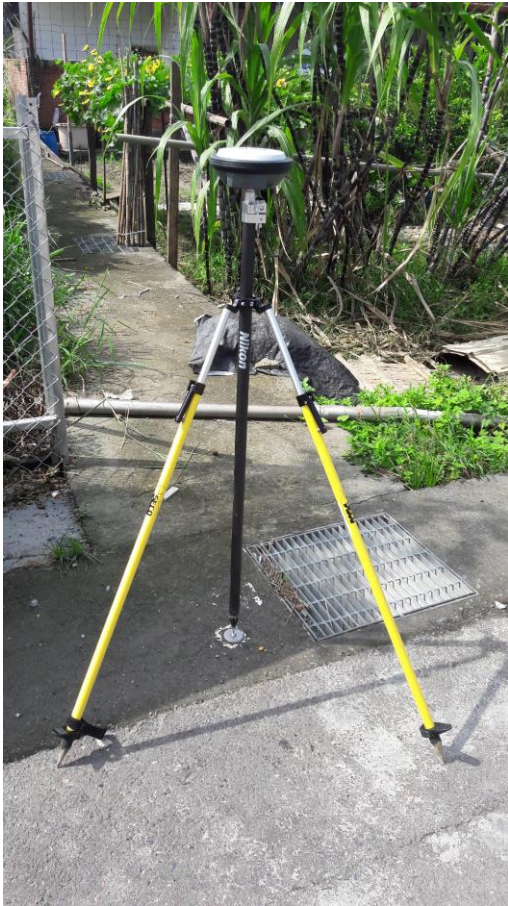
圖 4 以 Vrs-Rtk 現場實測情形
