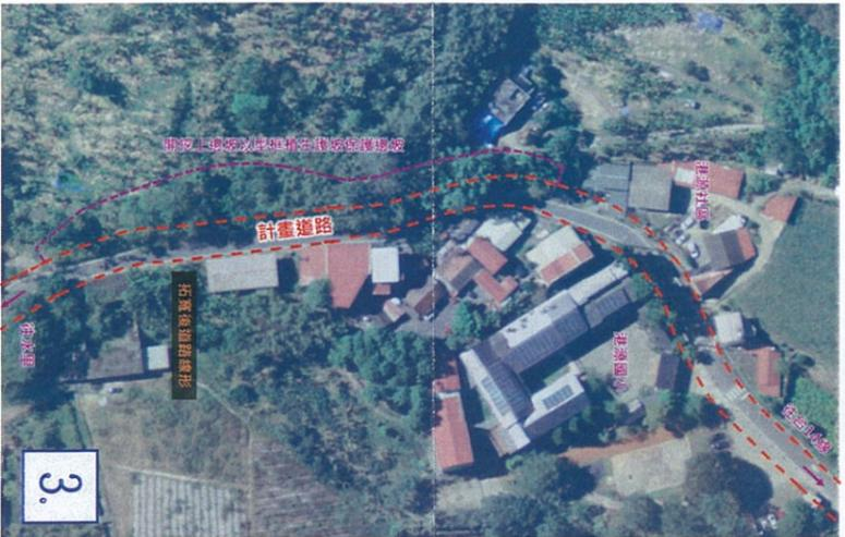
3. 本路段道路左側為港源國小，規劃路線在左側側偏移，可避免拆除既有合法建物，道路過港源國小後左側既為RC建物，規劃路線將往右側側偏移，配合新設地籍線形需求將開挖上邊坡，而邊坡則以植生護坡作為擋土設施。
