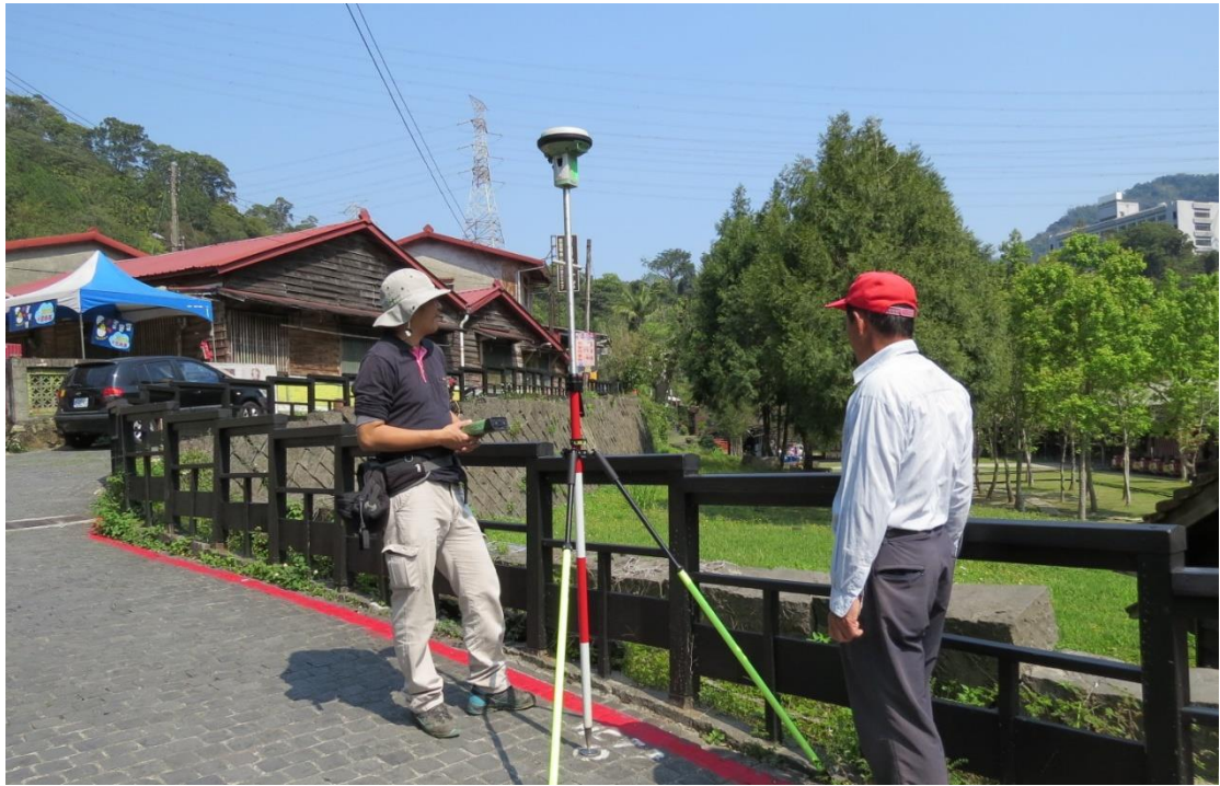
利用 e-GNSS 即時動態定位系統收集觀測資料
