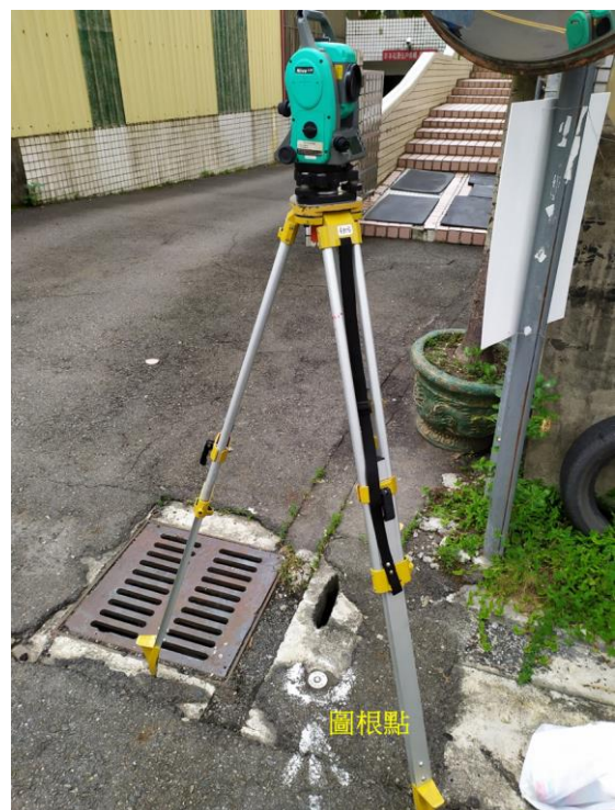
圖 18 現場補點與地測檢核現場照片
