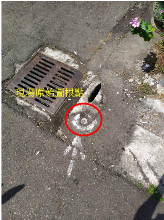
圖 17 現場已知原始圖根點為檢核標準現場照片
