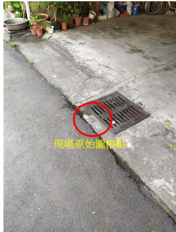
圖 17 現場已知原始圖根點為檢核標準現場照片
