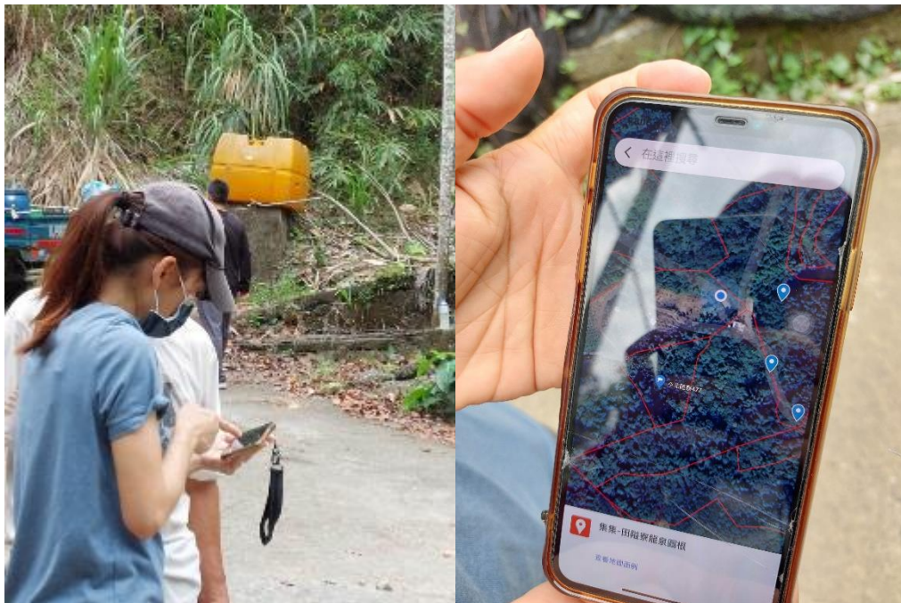
圖 5 藉由手機將地籍圖、控制點等資料顯示於行動裝置上
