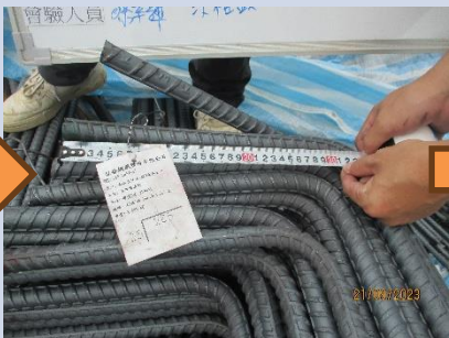
3. 彎鉤長度確認( \geq 12db 、 6db )
