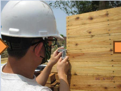
2. 厚度1.5cm，縫隙2mm
