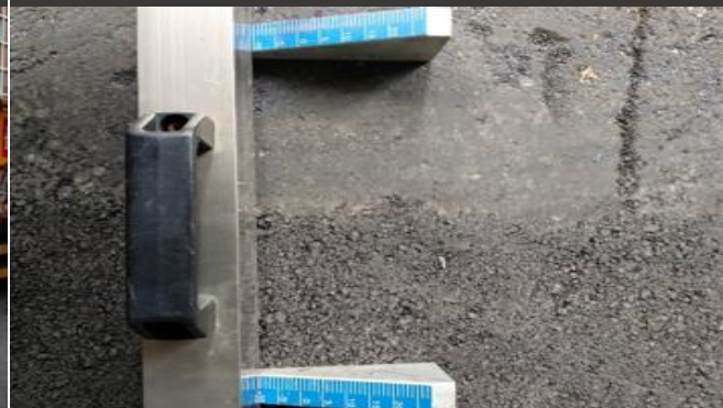
平坦度量測：高低差 < 6mm
