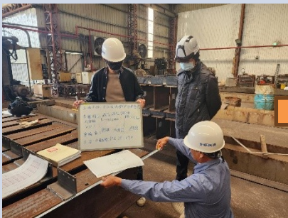
5. 鋼構加工完成廠驗
