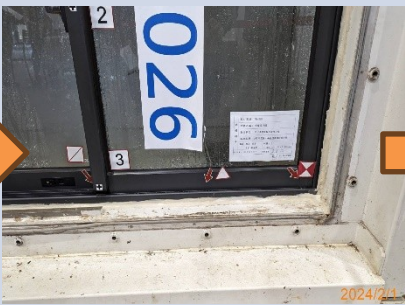
6. 程序 3- 水密性能試驗 (CNS11528)
