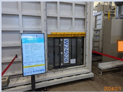
5. 程序 2- 氣密性能試驗 (CNS11527)
