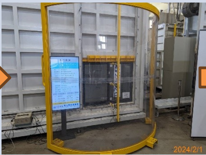
7. 程序 4- 抗風壓性能試驗 (CNS11526)
